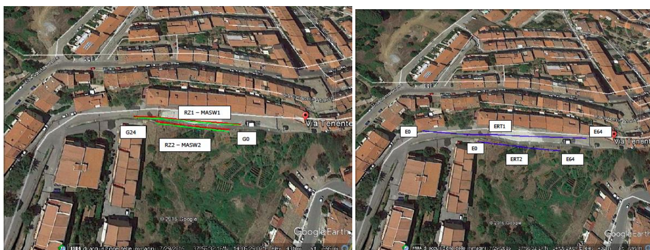
Fig. 2. Ubicazione delle traverse sismiche (RZ1 e RZ2) e traverse elettriche (ERT1 e ERT2) e indagini MASW (MASW1 e MASW2).
