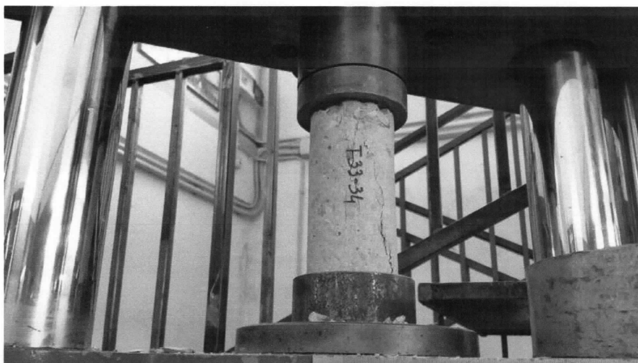
Figura 46 - Prova a compressione su carota T33-34
