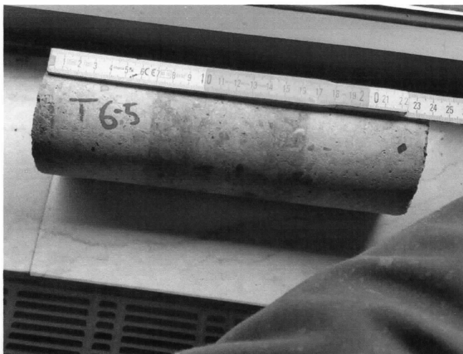
Figura 22 - Misura della profondità di carbonatazione sulla carota T6-5
