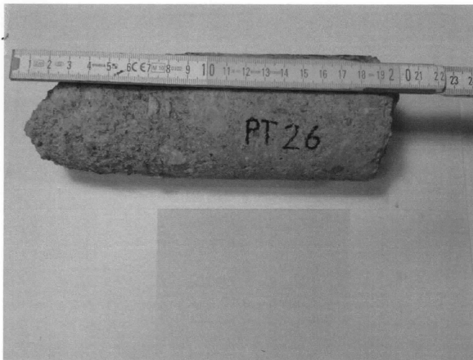
Figura 25 - Misura della profondità di carbonatazione sulla carota PT26 (interamente carbonatata)
