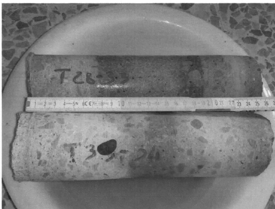
Figura 24 - Misura della profondità di carbonatazione sulle carote T28-33 e T33-34
