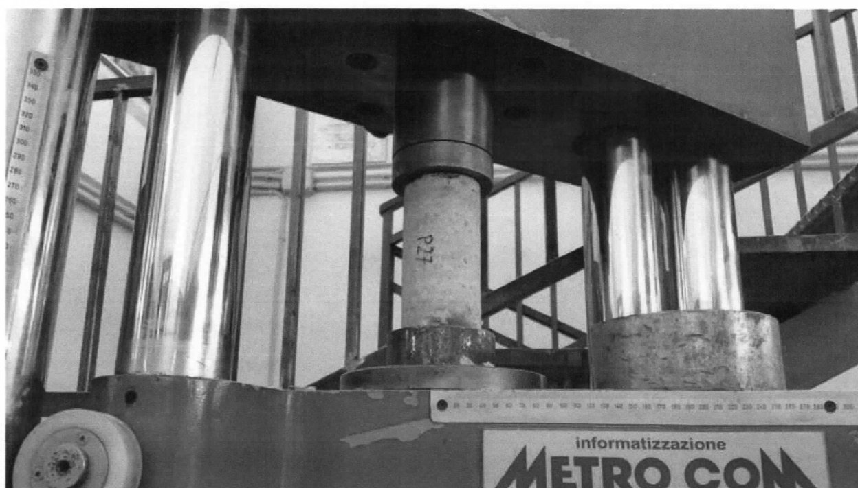
Figura 38 - Prova a compressione su carota P27
