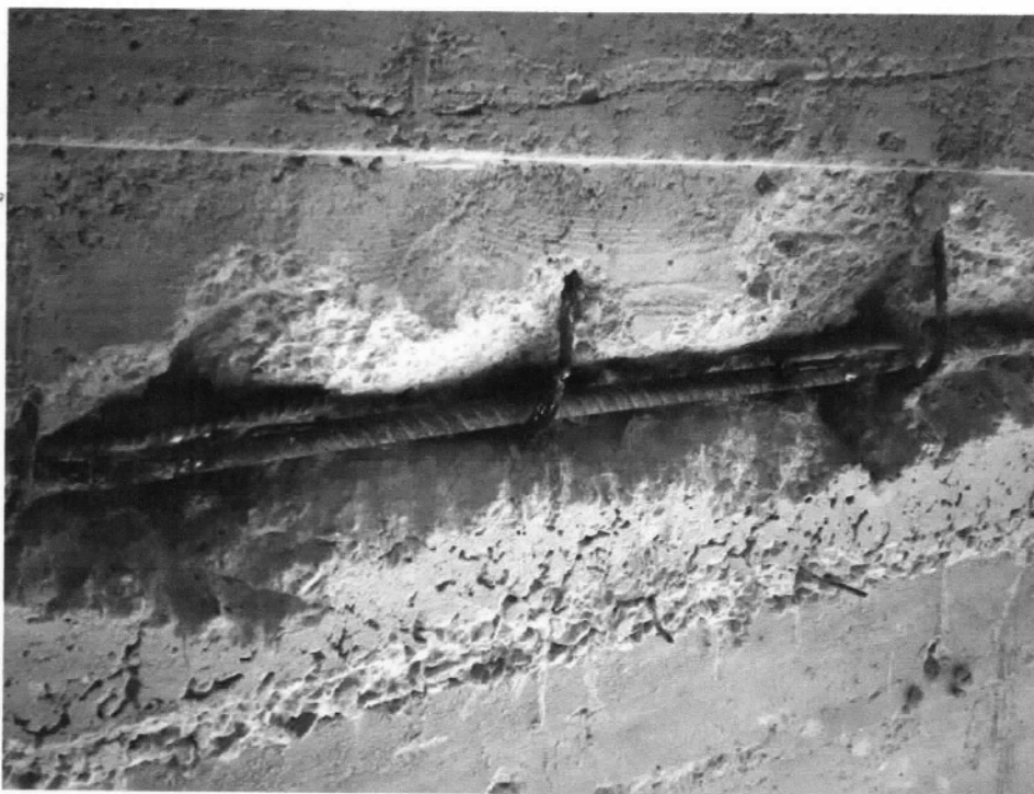
Figura 31 - Estrazione della barra di armatura FT6-5 dalla trave T6-5
