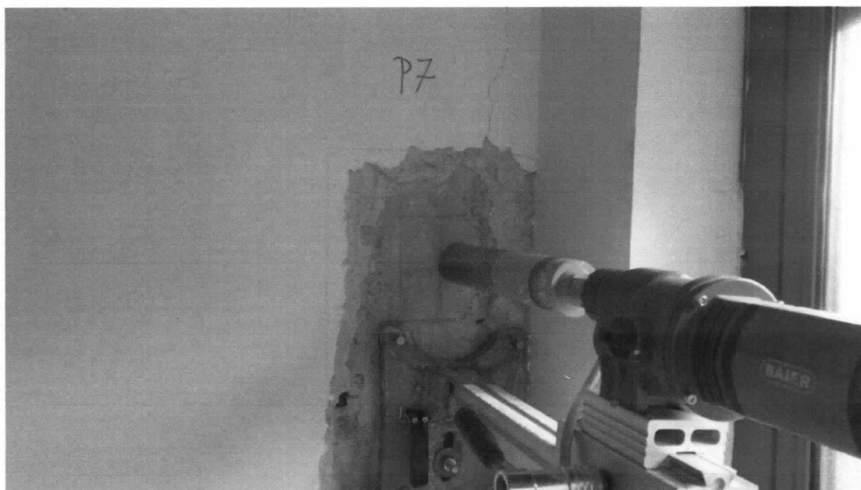
Figura 10 - Estrazione di carota di calcestruzzo indurito da pilastro P7
