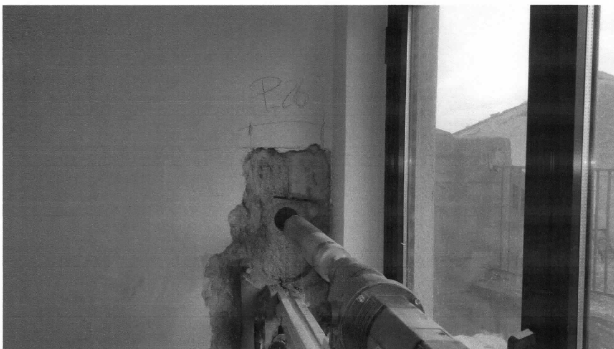
Figura 14 - Estrazione di carota di calcestruzzo indurito da pilastro PT26
