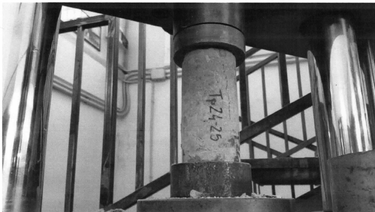
Figura 56 - Prova a compressione su carota TP24-25
