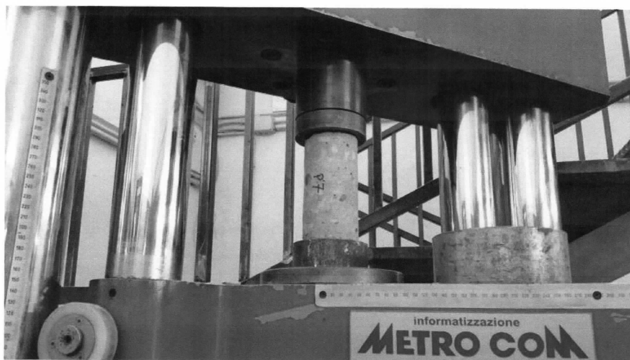
Figura 40 - Prova a compressione su carota P7
