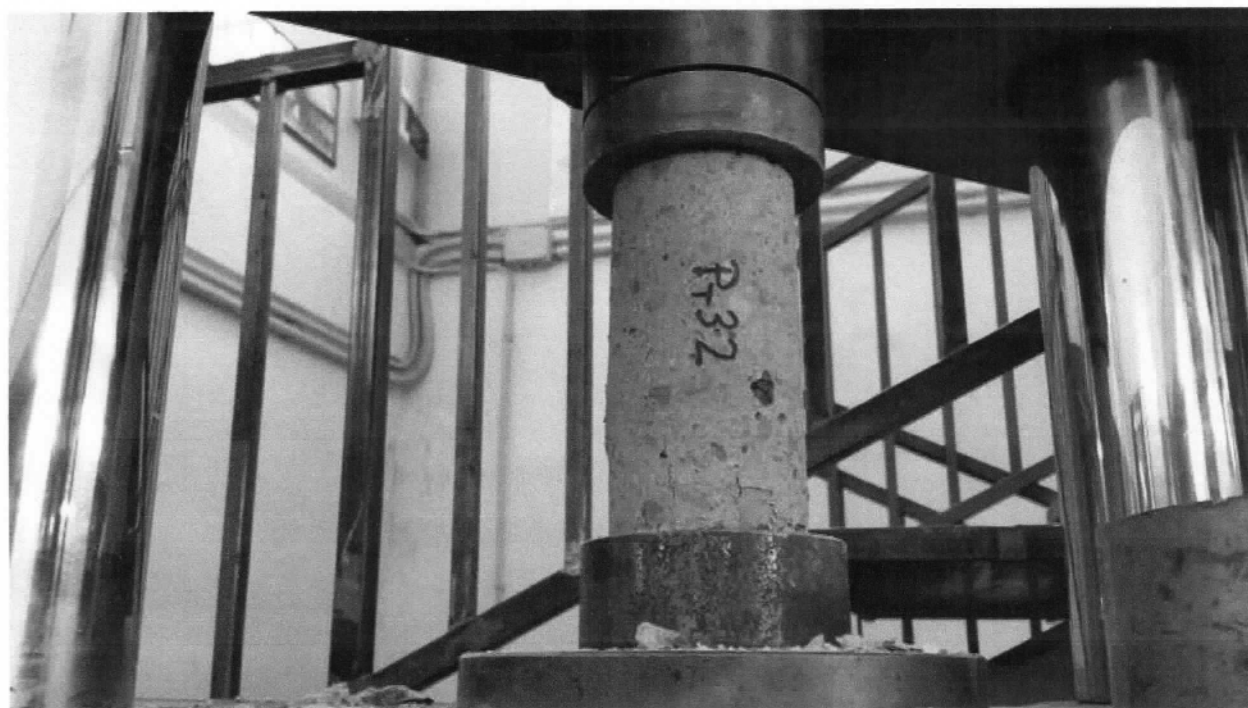
Figura 50 - Prova a compressione su carota PT32
