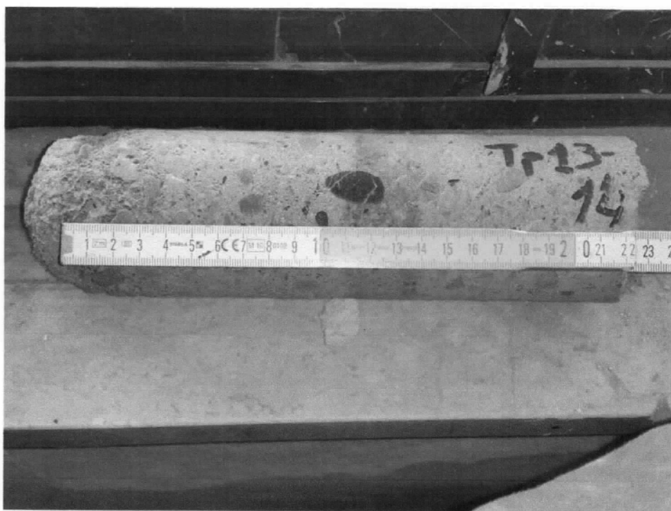
Figura 30 - Misura della profondità di carbonatazione sulla carota TP13-14
