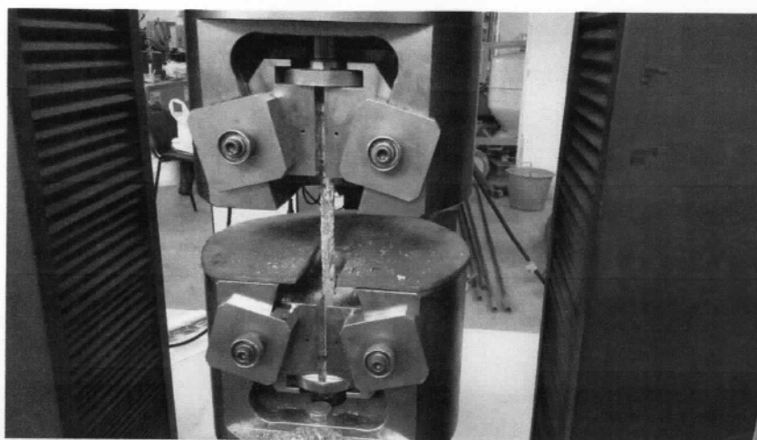
Figura 59 Barra estratta e sottoposta a prova di trazione
