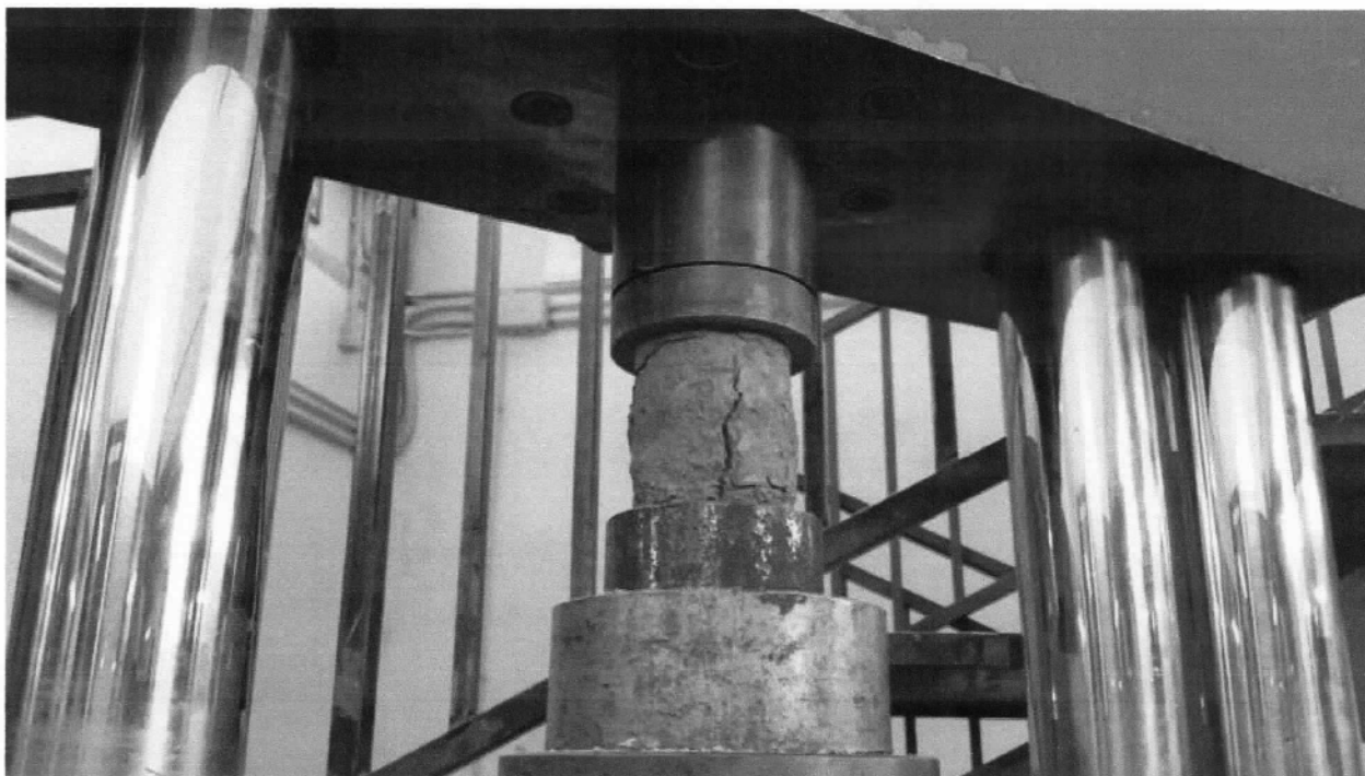
Figura 54 - Prova a compressione su carota TP33-34
