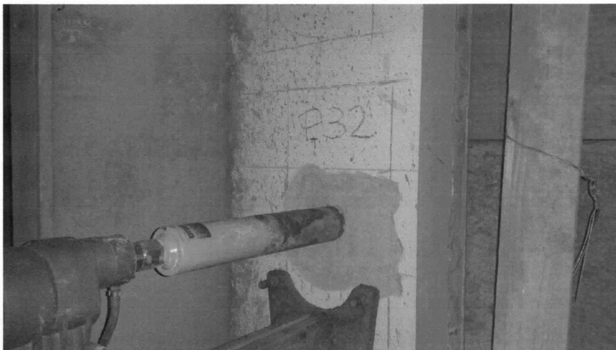
Figura 15 - Estrazione di carota di calcestruzzo indurito da pilastro PT32
