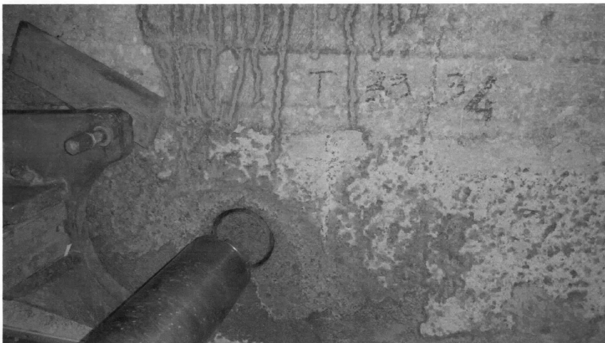
Figura 13 - Estrazione di carota di calcestruzzo indurito da trave 33-34 (secondo impalcato)
