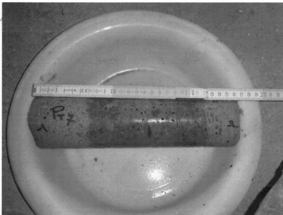
Figura 27 - Misura della profondità di carbonatazione sulla carota PT7
