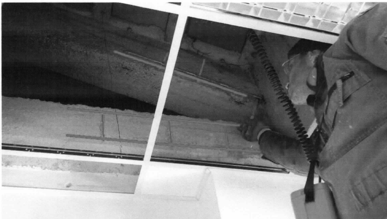
Figura 5 - Indagine pacometrica su trave T25-30 (secondo impalcato)
