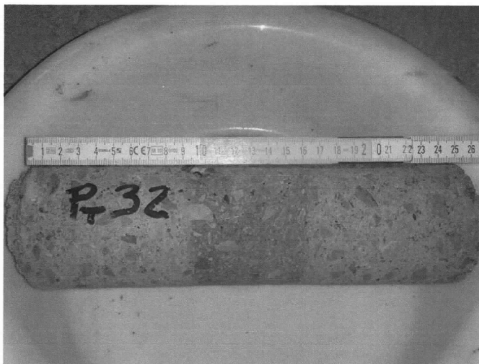
Figura 26 - Misura della profondità di carbonatazione sulla carota PT32
