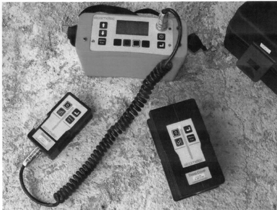
Figura 4 - Centralina pacometrica con sonda standard e sonda di profondità
