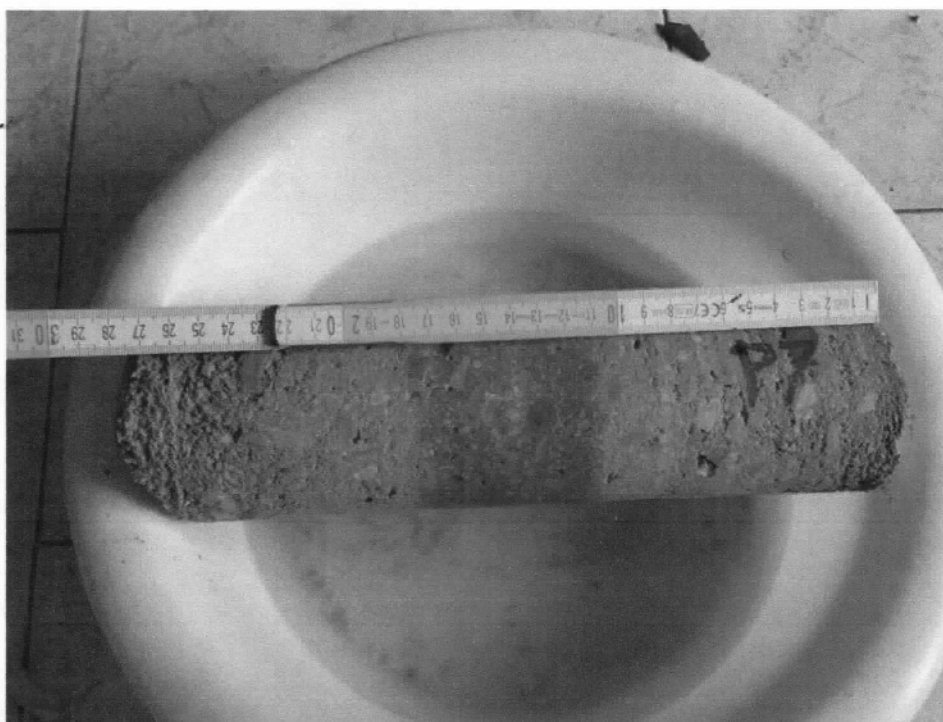
Figura 23 - Misura della profondità di carbonatazione sulla carota P7
