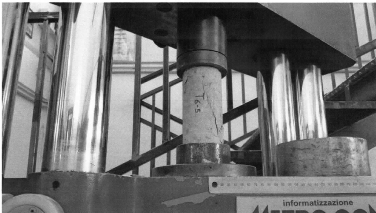
Figura 42 - Prova a compressione su carota T6-5
