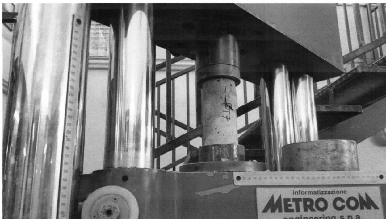
Figura 52 - Prova a compressione su carota PT7
