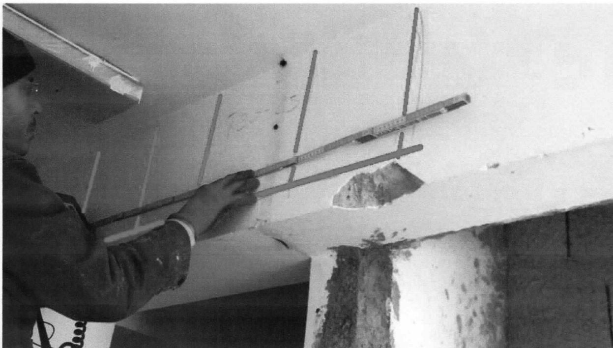
Figura 6 - Indagine pacometrica su trave TP30-25 (primo impalcato)
