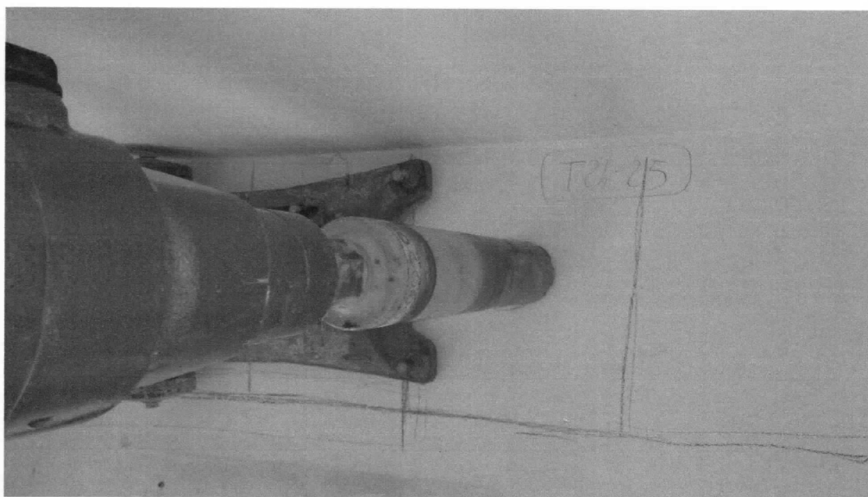
Figura 18 - Estrazione di carota di calcestruzzo indurito da trave TP24-25 (primo impalcato)
