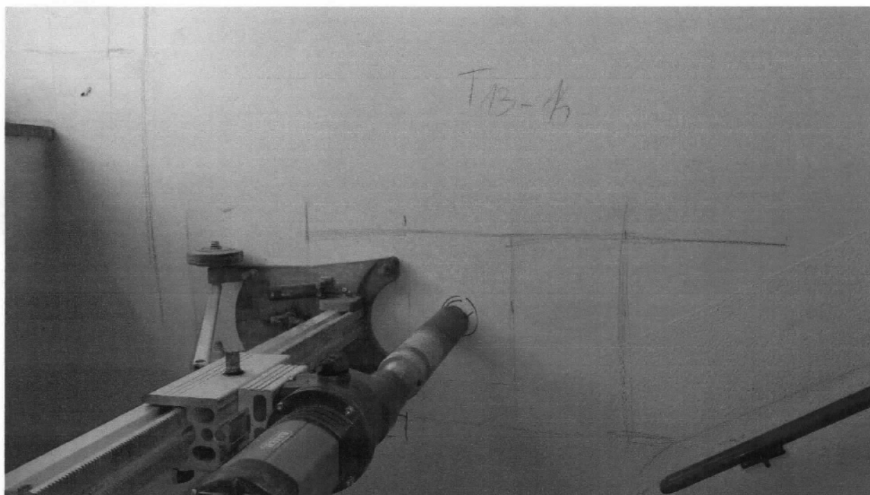
Figura 19 - Estrazione di carota di calcestruzzo indurito da trave TP13-14 (primo impalcato)
