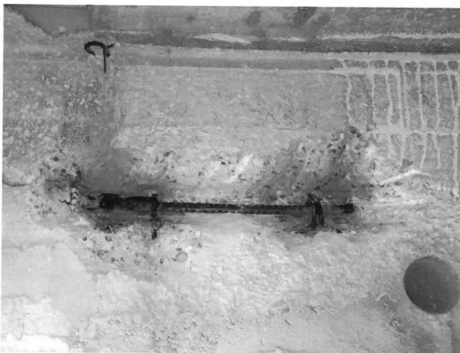
Figura 32 - Estrazione della barra di armatura FT33-34 dalla trave T33-34
